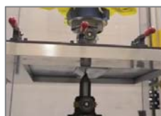
Slika 10: Inkrementalno oblikovanje lima u dvije tačke [9,10]
