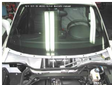
Slika 5: Principijelna shema neprikladnih i prikladnih spojeva (lijevo). Primjer lijepljenja vetrobranskog stakla luksuznog automobila (desno)
