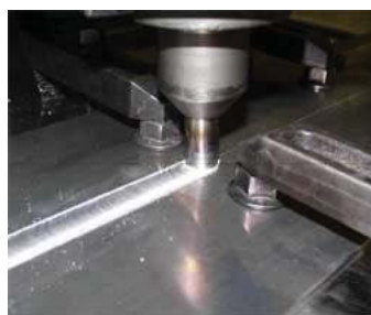
Slika 10: Principijelna shema FSW zavarivanja i primjer zavarivanja aluminija
