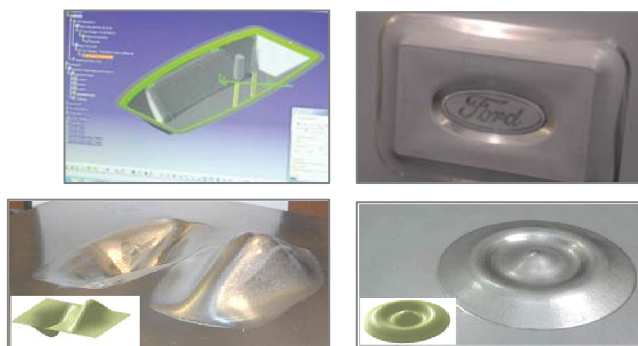
Slika 11: Simulacija procesa inkrementalnog oblikovanja i dobiveni dijelovi [9,10]
