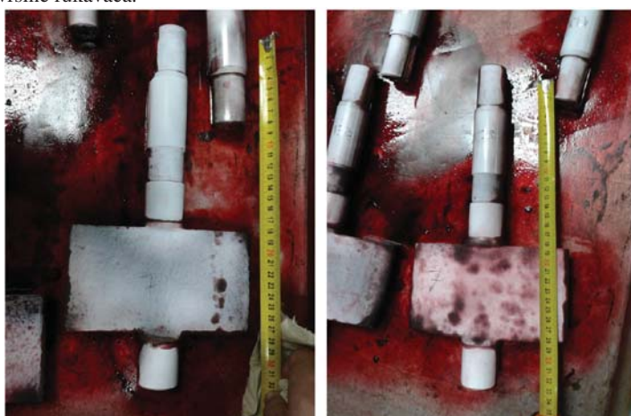
Slika 4: Jedna od vodećih lopatica nakon razvijanja penetranta
