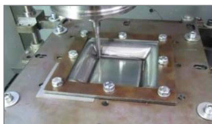
Slika 9: Postupak inkrementalnog oblikovanja lima u jednoj tački [3]
