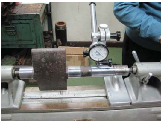
Slika 6: Aparatura za mjerenje radijalnog bacanja
